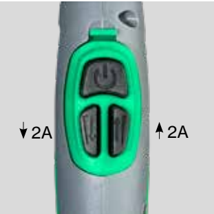
Up/Down Modul mit 3-Funktions-Tasten zur Einstellung des Schweißstroms. Der Schweißstrom wird in Stufen von 2 Ampere erhöht / verringert. Gedrückt halten für ständigen Anstieg / Abfall. Art. Nr. ....80300064* * Gilt Software-Versionen ab 2.17
