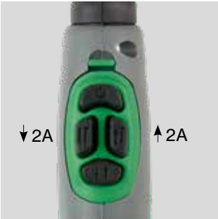
Up/Down Modul mit 4-Funktions-Tasten zur Einstellung des Schweißstroms inkl. TIG-A-Tack-Funktion. Der Schweißstrom wird in Stufen von 2 Ampere erhöht / verringert. Gedrückt halten für ständigen Anstieg / Abfall. Art. Nr. ....80300063* * Gilt Software-Versionen ab 2.17
