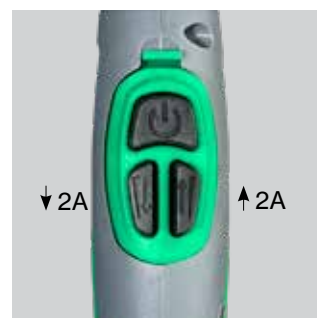
Up/Down modul med 3-knap-tast til justering af svejsestrøm. Svejsestrømmen forøges/reduceres med 2 ampere. Langt tryk for konstant forøgelse/reducering. Art. nr. ....80300064* * Gælder softwareversioner fra 2.17
