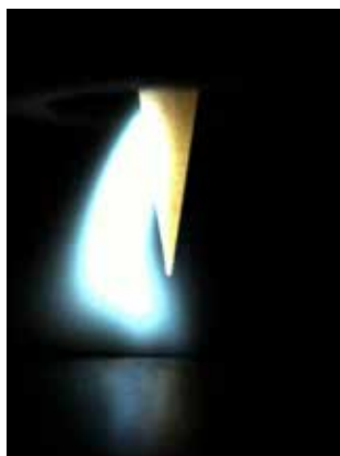
Lavkvalitets-wolfram: Lysbuen tænder oftest fra siden, lysbuen flakker og vandrer kun langsomt til elektrodespidsen, som skal skæres af og tilspidsets igen.
