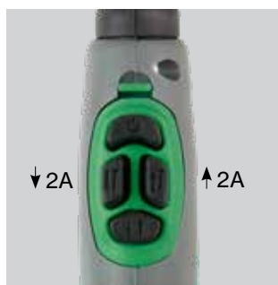
Up/Down modul med 4-knap-tast til justering af svejsestrøm inkl. TIG-A-Tack funktion. Svejsestrømmen forøges/ reduceres med 2 ampere. Langt tryk for konstant forøgelse/ reducering. Art. nr. ....80300063* * Gælder softwareversioner fra 2.17
