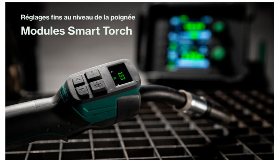
Accédez facilement aux réglages précis des paramètres de soudage au niveau de la poignée.
