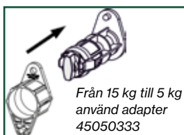
Justering av trådbroms 15 kg
