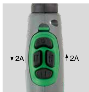
Up/Down modul med 4-knapps- avbrytare för justering av svets- ström inkl. TIG-A Tack funktion. Svetsströmmen ökas/minskas med 2 ampere. Långt tryck för konstant ökning/minskning. Art. nr. ....80300063* * Gäller softwareversioner från 2.17
