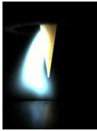
Lågkvalitets-wolfram: Ljusbågen tändes oftast från sidan, ljusbågen flackar och vandrar endast långsamt till elektrodspetsen, som skall skäras av och tillspetsas igen
