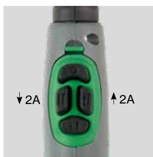
Módulo ascendente / descendente con 4 funciones tecla para el ajuste de la corriente de soldadura incl. Función TIG-A Tack. La corriente de soldadura es incrementada/reducida en 2 amps. Presionar de forma constante para aumentar/disminuir. Art. no. ....80300063* * Se aplica a las versiones de software a partir de 2.17
