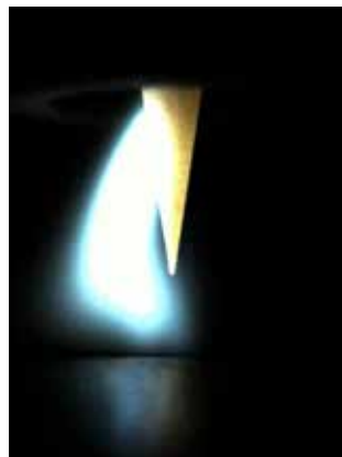
Tungsteno de baja calidad: típico encendido de arco lateral, el arco parpadea y da vueltas lentamente alrededor de la punta del electrodo que se debe cortar y reafilarse.
