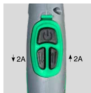
Módulo ascendente / descendente con 3 funciones tecla para el ajuste de la corriente de soldadura. La corriente de soldadura es incrementada/reducida en 2 amps. Presionar de forma constante para aumentar/disminuir. Art. no. ....80300064* * Se aplica a las versiones de software a partir de 2.17
