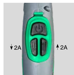
Il Modulo Up/Down con i comandi 3 funzioni per la regolazione della corrente di saldatura. La corrente di saldatura viene aumentata / ridotta di 2 ampere. Premere a lungo per aumentare / diminuire costantemente. N. art. ....80300064* * Si applica alle versioni software a partire dalla 2.17
