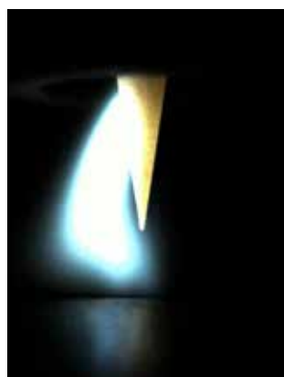
Électrode tungstène de mauvaise qualité : amorçage de l'arc latéral caractéristique de ce type d'électrode ; l'arc est amorcé et atteint lentement l'extrémité de l'électrode, qui doit être coupée et réaffûtée.
