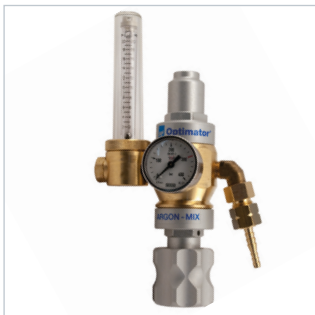
ARGON/H2 OPTIMATOR 1 DURCHFLUSSMESSER Argon/H2 Optimator mit eingebautem Gassparer. Bis zu 50% Gaseinsparung. Reduziert das Wechseln der Gasflaschen, was sich positiv auf Wirtschaftlichkeit und Effizienz auswirkt. Gasflaschengewinde: 21,8x14/1"LH Anschlussgewinde Maschine: G3/8"LH Artikel-Nr. ....81963048
