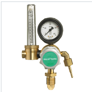
ARGON/MIX OPTIMATOR 1 DURCHFLUSSMESSER ANSCHLUSS UNTEN Argon/Misch Optimator mit eingebautem Gassparer. Bis zu 50% Gaseinsparung. Reduziert das Wechseln der Gasflaschen, was sich positiv auf Wirtschaftlichkeit und Effizienz auswirkt. Gasflaschengewinde: W21,8x14/1" Anschlussgewinde Maschine: G1/4" Artikel-Nr. ....81963080
