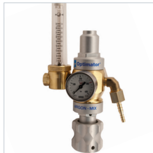
ARGON/MIX OPTIMATOR 1 DURCHFLUSSMESSER Argon/Misch Optimator mit eingebautem Gassparer. Bis zu 50% Gaseinsparung. Reduziert das Wechseln der Gasflaschen, was sich positiv auf Wirtschaftlichkeit und Effizienz auswirkt. Gasflaschengewinde: W21,8x14/1" Anschlussgewinde Maschine: G3/8" Artikel-Nr. ....81963309
