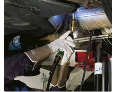
Hitsausparametrien säätö Dialog-polttimen avulla
