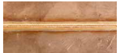
Kupfer – Plasma-Schweißen in 0,6 mm Materialstärke
