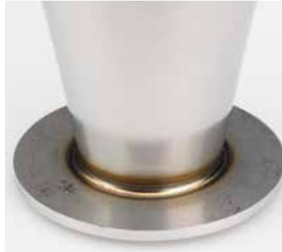
Kegelförmiges Rohr WIG-geschweißt auf Platte mit kleinem A-Maß.
