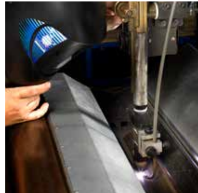
Plasmaschweißen von legiertem Stahl in Längsnahtautomat
