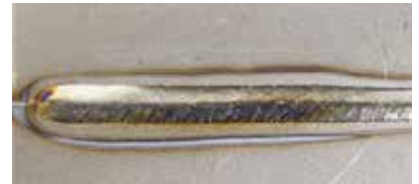
Edelstahl – Stichloch-Schweißen in 6 mm Materialstärke
