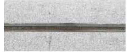
Stahl – Plasma-Schweißen in 0,5 mm Materialstärke
