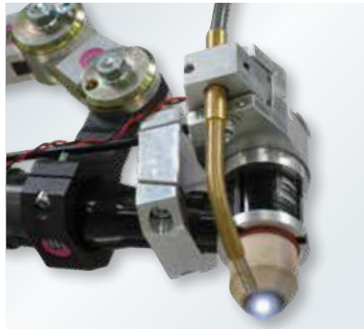
Geschützte Wolframelektroden – erhöhte Standzeit der Elektroden
