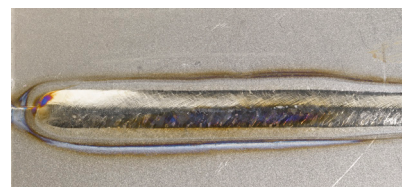
Rostfritt stål – Plasma –keyhole i 6 mm godstjocklek
