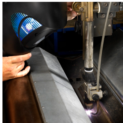
Plasma i längdsvetsautomat – rostfritt svep
