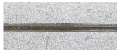
Galvaniserat svart stål – Plasma-smälta i 0,5 mm godstjocklek
