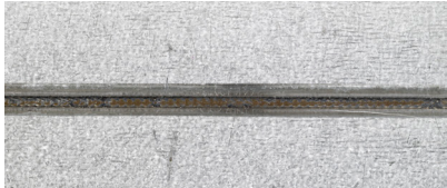
Galvaniseret sort stål – Plasma-smelte i 0,5 mm godstykkelse
