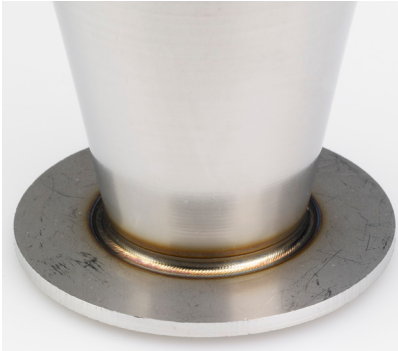
Kegleformet rør TIG svejset til plade. Bemærk det lille A-mål
