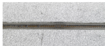
Pozinkovaný ocelový plech – tavná plazma na tloušťce 0,5 mm
