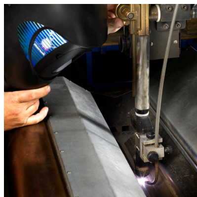
Plazmové svařování nerezové oceli na automatu pro podélné svařování.
