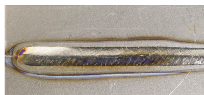
Nerezová ocel – průvarová plazma na tloušťce 6 mm
