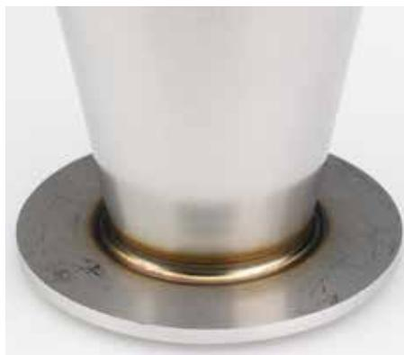
Acero dulce galvanizado: soldadura por microplasma en un grosor de pared de 0,5 mm.
