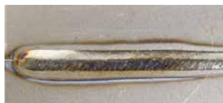
Cobre: soldadura por microplasma en un grosor de pared de 0,6 mm.
