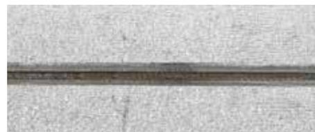
Acero inoxidable: soldadura "keyhole" u ojo de cerradura en un grosor de pared de 6 mm.
