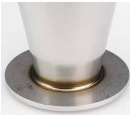
Plasma-keyholelas van 6 mm roestvast staal
