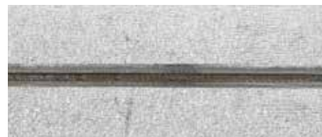
Plasma-keyholelas van 6 mm roestvast staal
