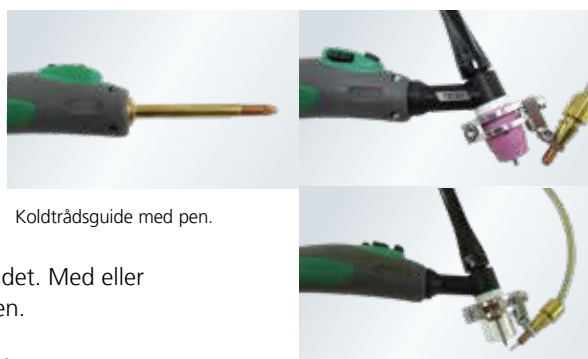
Koldtrådsguide monteret på svejse-slange.
