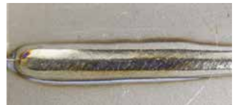
Kupfer – Plasma-Schweißen in 0,6 mm Materialstärke
