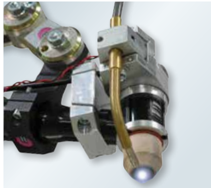
Geschützte Wolframelektroden – erhöhte Standzeit der Elektroden
