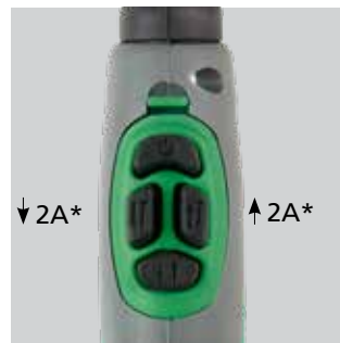
Up/Down modul med 4-knap-tast til justering af svejsestrøm inkl. TIG-A Tack funktion. Svejsestrømmen forøges/reduceres med 2 amperet. Langt tryk for kon- stant forøgelse/reducering. 80300063
