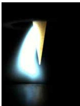
Lav kvalitets-wolfram: Lysbuen tænder oftest fra siden, lysbuen flakker og vandrer kun langsomt til elektrodespidsen, som skal skæres af og tilspidses igen.
