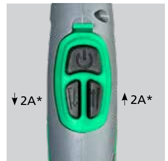
Up/Down modul med 3-knap-tast til justering af svejsestrøm. Svejsestrømmen forøges/reduceres med 2 amperet. Langt tryk for konstant forøgelse/reducering. 80300064
