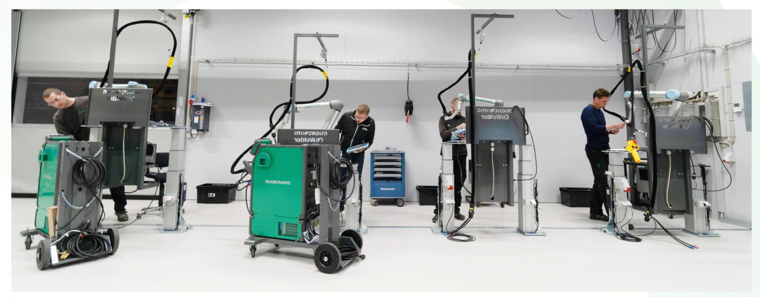
"Con CoWelder, i dipendenti devono solo presentare i pezzi al robot di saldatura, che è dotato di un alimentatore a filo freddo in grado di rifornire automaticamente il materiale d'apporto il materiale d'apporto nel bagno di saldatura. "Abbiamo ottimizzato la nostra produzione TIG grazie all'efficienza ed all'elevata qualità delle saldature eseguite da CoWelder".
