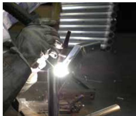
La Focus TIG 200 AC/DC HP è dotata di elettrodi di tungsteno MIGA Super Blue, con eccellenti proprietà di accensione e riaccensione, utilizzabili per ogni tipo di materiale.
