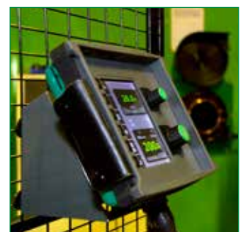
Remote MIG 2 - fjernbetjening med grafisk display.
