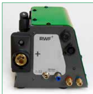
RWF 2 – kompakt feeder for MIG med 4-hjulstræk og elektronisk tachostyring af trådhastighed
