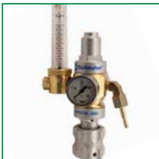
ARGON/MIX OPTIMATOR 1 DURCHFLUSSMESSER Argon/Misch Optimator mit eingebautem Gassparer. Bis zu 50% Gaseinsparung. Reduziert das Wechseln der Gasflaschen, was sich positiv auf Wirtschaftlichkeit und Effizienz auswirkt. Gasflaschengewinde: W21,8x14/1" Anschlussgewinde Maschine: G3/8" Artikel-Nr. ....81963309
