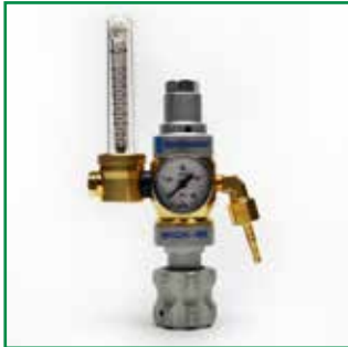
ARGON/MIX OPTIMATOR 1 DURCHFLUSSMESSER Argon/Misch Optimator mit eingebautem Gassparer. Bis zu 50% Gaseinsparung. Reduziert das Wechseln der Gasflaschen, was sich positiv auf Wirtschaftlichkeit und Effizienz auswirkt. Gasflaschengewinde: 24,32x14/1" Anschlussgewinde Maschine: G3/8" Artikel-Nr. ....81963041
