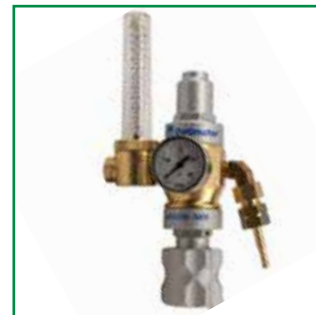
ARGON/MIX OPTIMATOR 1 DURCHFLUSSMESSER Argon/Misch Optimator mit eingebautem Gassparer. Bis zu 50% Gaseinsparung. Reduziert das Wechseln der Gasflaschen, was sich positiv auf Wirtschaftlichkeit und Effizienz auswirkt. Gasflaschengewinde: W21,8x14/1" Anschlussgewinde Maschine: G3/8" Artikel-Nr. ....81963309
