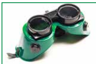
SVETS-/SLIPGLASÖGON Kombinerade svets- och slipglasögon med runda glas i carborock. Slipglasögonen är fasta, medan svetsglasögonen kan vippas. Flera möjligheter för isättning av glas allt efter behov och användning. Använder glas i ø50 mm.
