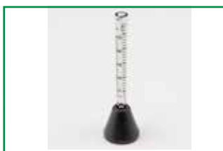
FLOWMÅLER Gasflowmåler til kontrol af det faktiske gasflow i gaskoppen.
