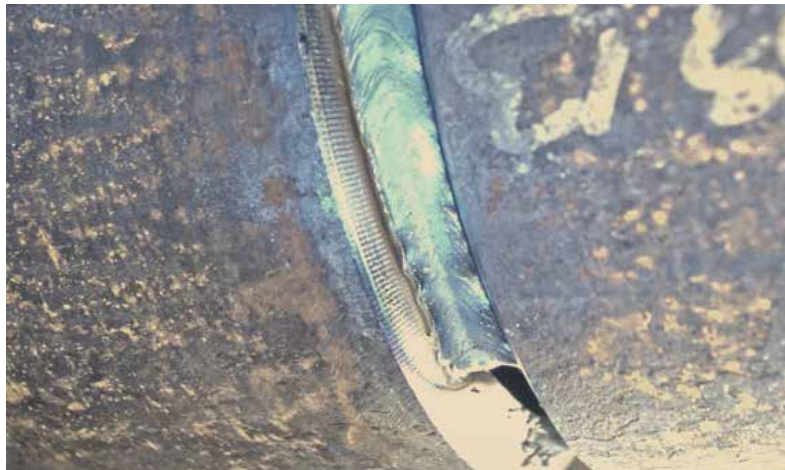
IAC™ - Soldadura vertical descendente de um cordão de raiz num tubo de aquecimento urbano. Aumento significativo da velocidade de soldadura comparado com a soldadura tradicional ascendente.
