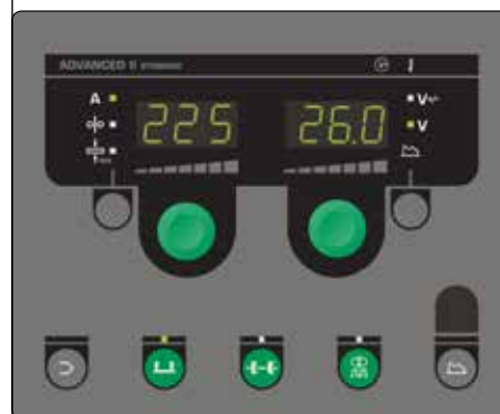
Panel Advanced que incluye, entre otras cosas, PowerArc™ y DUO Plus™. DUO Plus ofrece una soldadura de apariencia tipo TIG y un mejor control del baño de soldadura. El panel incluye programas para soldadura fuerte MIG y soldadura normal con hilo de núcleo fundente o sólido en aceros dulces, acero inoxidable y aluminio.
