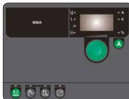
Pi MMA Panel de control MMA, con la opción de proceso TIG con encendido LIFTIG® simple
