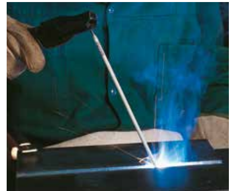
MMA in un giunto a V
