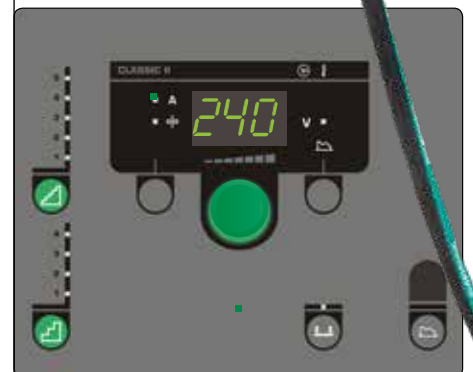
Classic-paneeli hitsauslaitteen manuaaliseen ohjaukseen – mukaan lukien rajattomasti säädettävän invertterin edut
