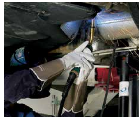
Hitsausparametrien säätö Dialog-polttimen avulla
