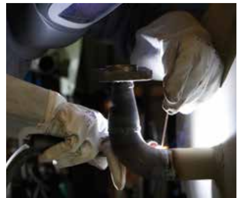
Focus Tig 200 DC HP PFC svetsar i svart och rostfritt stål och andra DC- svetsbara material
