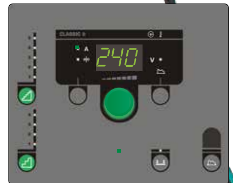
Classic panel til manuel betjening af svejsemaskinen - med den trinløse inverters fordele
