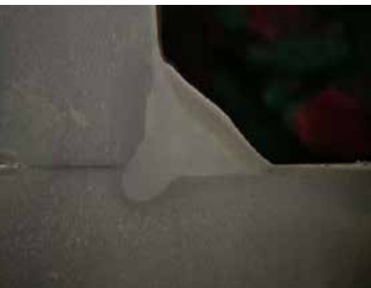
PowerArc™ sikrer dyb indtrængning ved kant- og stumpsømme og øget svejsehastighed i sort og rustfrit stål.
