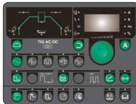
Pi AC/DC med D.O.C. ® TIG AC/DC betjeningspanel med alle ønskede parametre for professionel svejsning i alle materialer.
