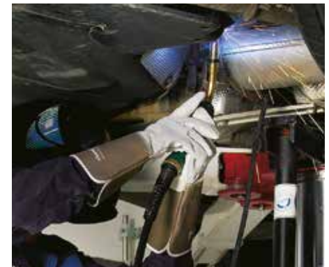
Trimning af svejseparametre direkte fra Dialog brænder
