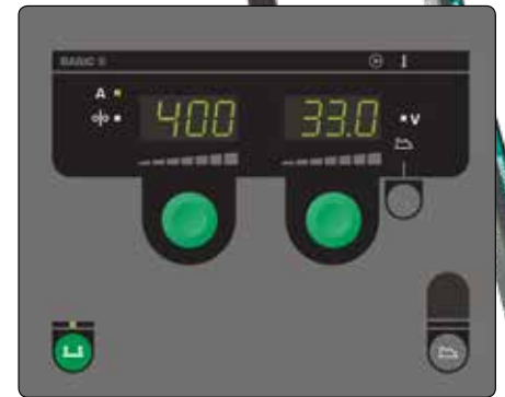
Basic-Panel mit manueller Einstellmöglichkeit der Schweißaufgaben
