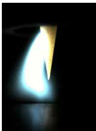
Lågkvalitets-wolfram: Ljusbågen tänds oftast från sidan, ljusbågen flackar och vandrar endast långsamt till elektrodspetsen, som skall skäras av och tillspetsas igen.
